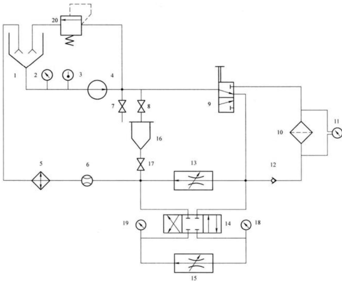
1——油箱<sup>a</sup>; 2——压力表; 3——温度计; 4——泵; 5——冷却器; 6——流量计; 7——取样阀; 8——截止阀;
