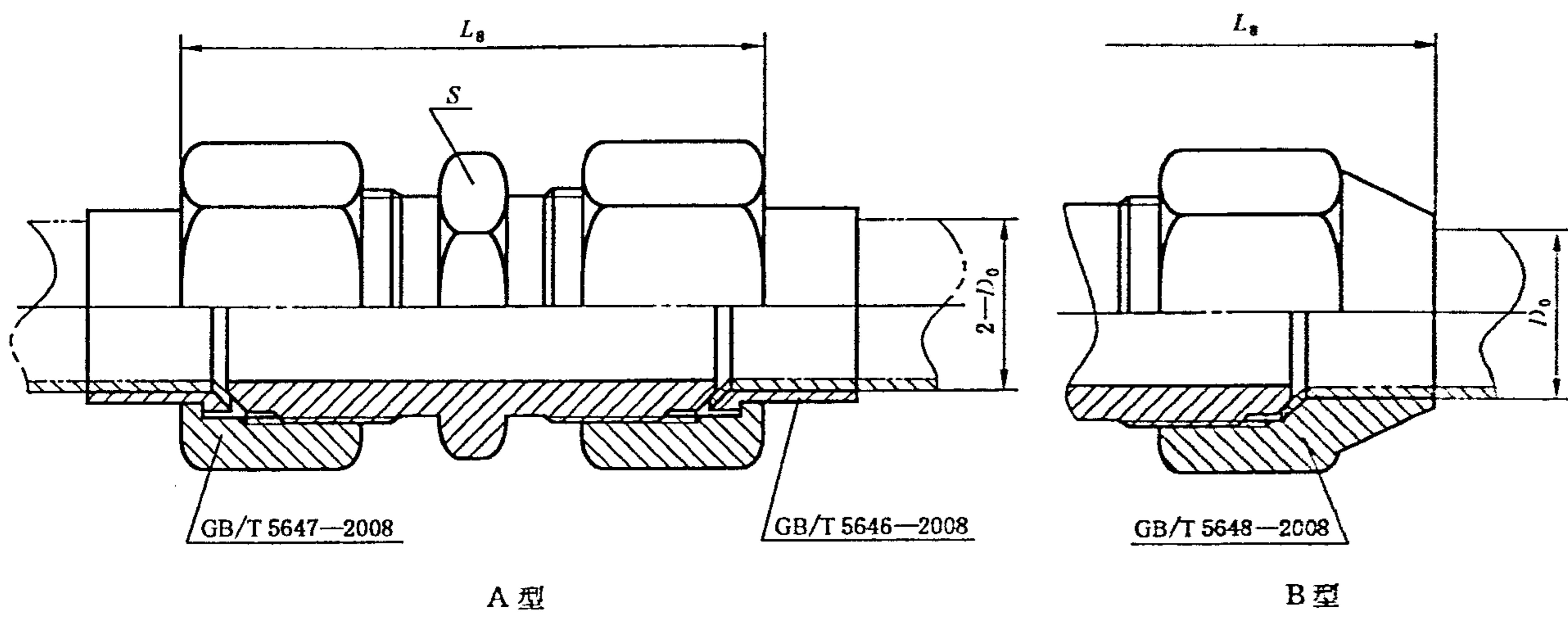
图 1 扩口式直通管接头
