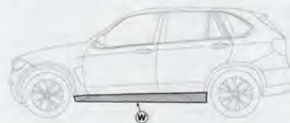
图16 安装左侧围护板W
