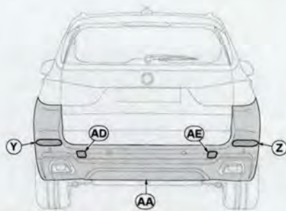
图18 安装后保险杠护板AA
