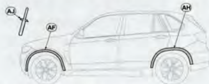
图19 安装左前轮眉饰边AF、AH
